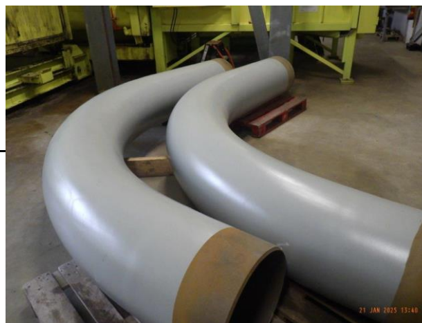
Foto 8 90 graden bochten, klaar voor montage.
