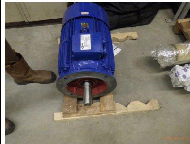
Foto 44 Gereviseerde elektromotor op voorraad.
