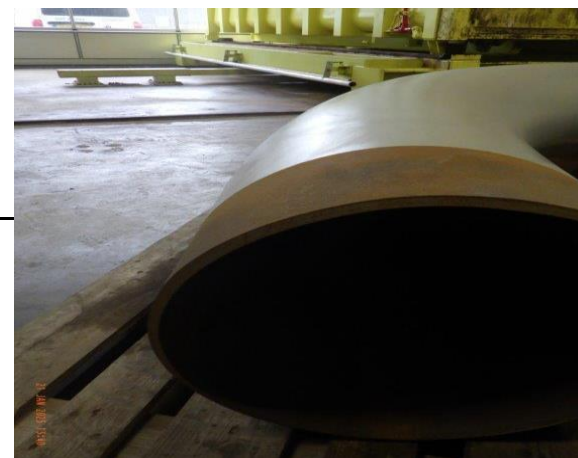
Foto 9 90 graden bochten, klaar voor montage.
