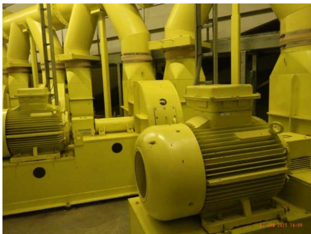
Foto 42 Trilling insectie gepland 2025 assen van motoren
