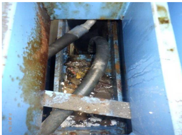
Foto 39 Kartonshredder corrosie door lekkage vanaf plafond (DV13.1).
