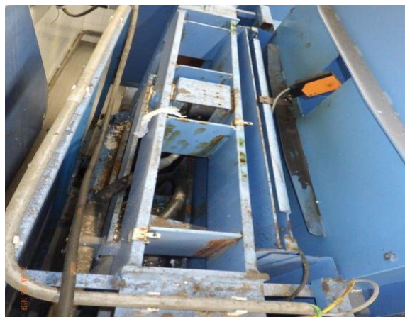
Foto 40 Kartonshredder corrosie door lekkage vanaf plafond (DV13.1).
