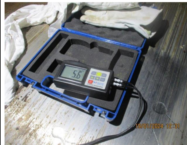
Foto 21 Dikte meting bodem contractor
